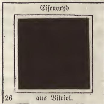
welche der Eisenvitriol enthält, entfernt, er besteht dann aus Schwefelsäure und Eisenoxyd. Durch die Hitze beim Destilliren werden dann beide von einander getrennt, die Säure geht in die Vorlage über, und das Eisenoxyd (Caput mortuum) bleibt als Rückstand in der Retorte.
